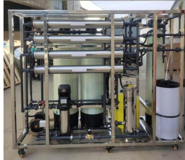
蒸汽发生器特供型-前加药+后软化
