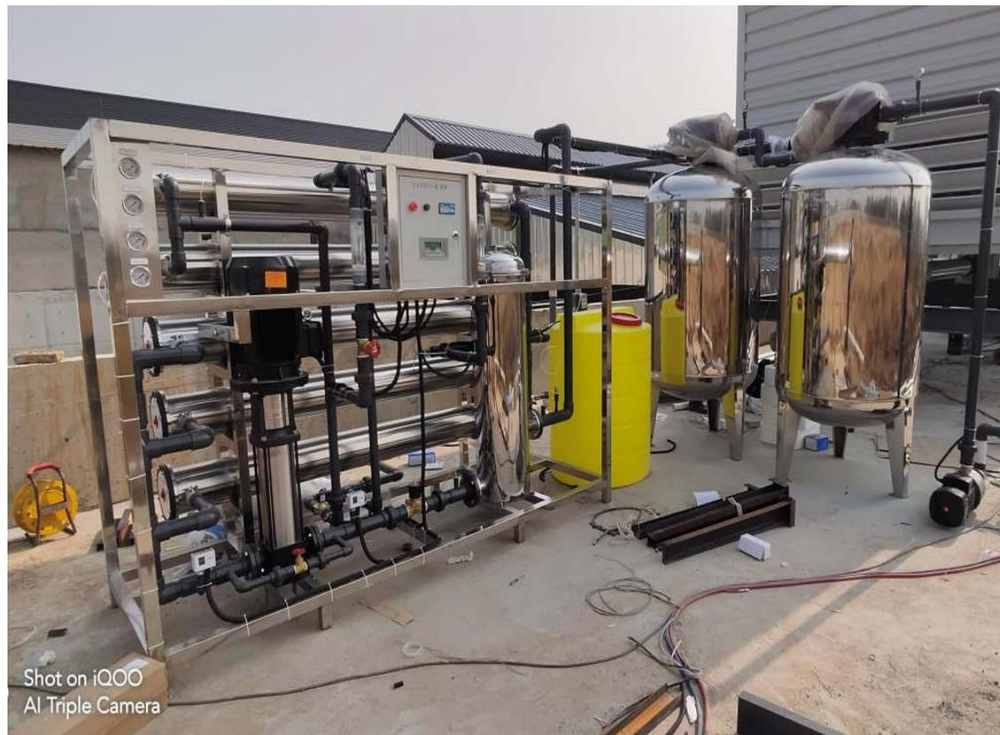
石市五七二一工厂 10T单级级反渗透设备
